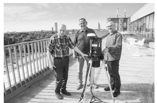
LU Ģeodēzijas un ģeoinformātikas institūta izstrādātā augstas precizitātes digitālā zenitkamera gravitācijas lauka mērījumiem. No kreisās: ĢĢI pētnieks Augusts Rubans , ĢĢI direktors Gunārs Silabriedis , ĢĢI vadošais pētnieks Ansis Zariņš pie digitālās zenitkameras
